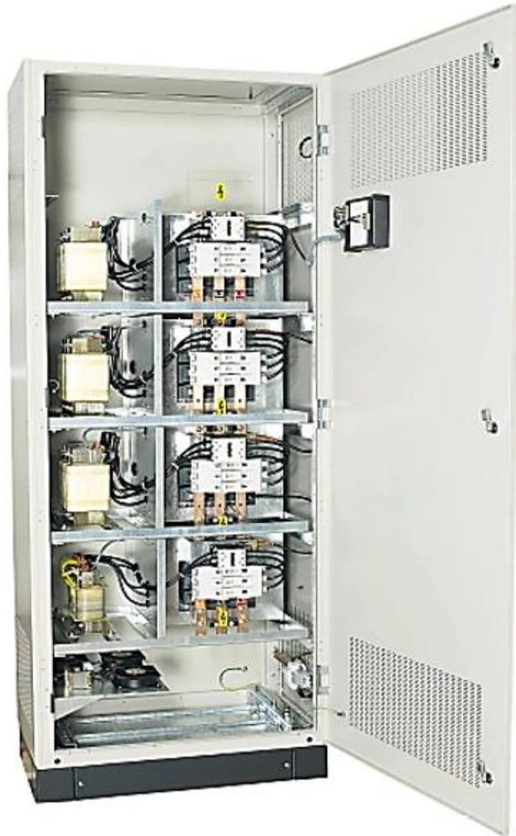
**ESCALÓN DE COMPENSACIÓN:** un paso pequeño permite una compensación más precisa, por ejemplo: 150 kVAr en 6 pasos de 25 kVAr se necesitan solo tres condensadores 25 + 50 + 75 kVAr .
