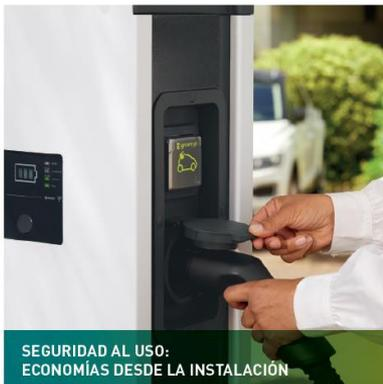
Para cargar con total seguridad, las estaciones Green'Up y Green'Up metal integran un dispositivo de detección de fuga de corriente 6 mA DC. Esto permite usar aguas arriba una protección diferencial tipo A, más económica y más compacta que una tipo B. En paralelo, Legrand recomienda el uso de una protección con inmunidad reforzada tipo F, en particular para instalaciones con importantes cargas electrónicas. Se integra también una protección para enchufe modo 2.
